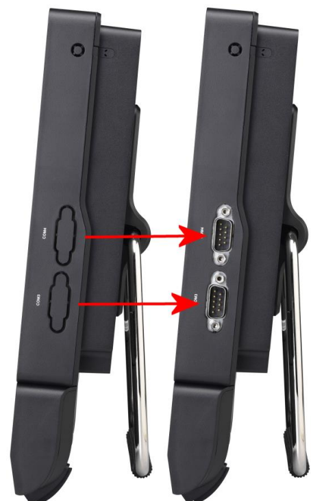
Shuttle XPC all-in-one P20U vor und nach dem Einbau von PCP21
