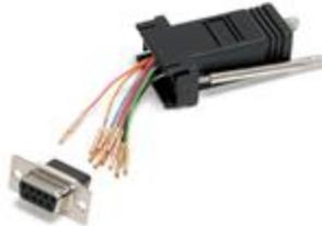
L'adaptateur modulaire GC98FF comprend un connecteur DB9 femelle et un connecteur RJ45 femelle. Utilisé pour des connexions modulaires RS232, RS422 et RS485, cet adaptateur convertit votre connecteur DB9 mâle en connecteur RJ45 femelle. L'adaptateur permet de réaliser des configurations de sorties série personnalisées.
