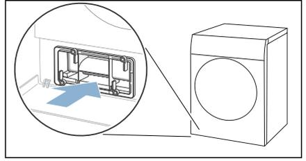
**Avvertenza:** È possibile inserire il coperchio dello scambiatore di calore soltanto se l'inserito si trova nell'apparecchio.
