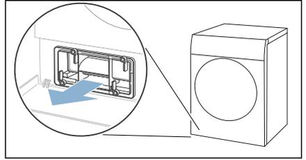
6. Estrarre con cautela il materiale filtrante dal coperchio dello scambiatore di calore.
