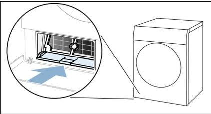
11. Inserire il coperchio dello scambiatore di calore sulla maniglia.
