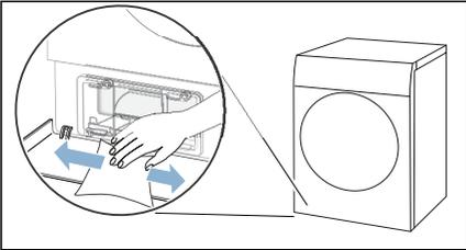
4. Sbloccare la leva del coperchio dello scambiatore di calore.
