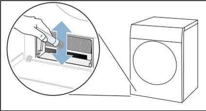
**Avvertenza:** Prestare attenzione a pulire le lamelle dello scambiatore di calore procedendo dall'alto verso il basso senza piegarle né danneggiarle.
