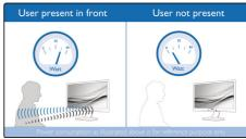
PowerSensor es un "sensor de personas" incorporado que transmite y recibe señales infrarrojas inofensivas para determinar si el usuario está presente y reduce automáticamente el brillo del monitor cuando se ausenta, reduciendo el gasto energético hasta un 80 % y prolongando la vida del monitor.
