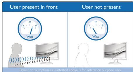
PowerSensor è un sensore integrato che rileva la presenza delle persone. Trasmette e riceve segnali infrarossi non nocivi per determinare l'eventuale presenza di un utente. Se l'utente si allontana dalla scrivania il sensore riduce automaticamente la luminosità dello schermo, riducendo i costi energetici fino all'80% e prolungando la durata di utilizzo dell'apparecchio
