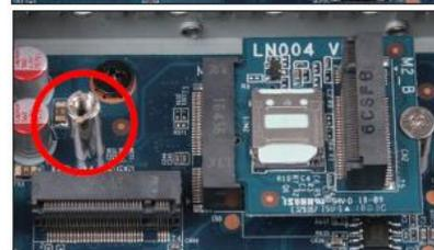
6. Installieren Sie das 4G/LTE-Modul in die M.2-Adapterplatine und schrauben Sie es fest.
