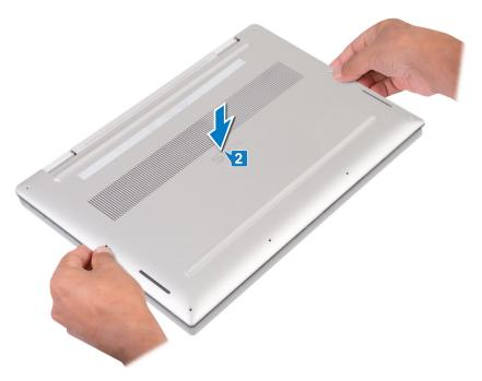
3 Encastre la cubierta de la base en las lengüetas del ensamblaje del reposamanos y del teclado.
