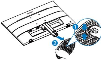
3. Entfernen Sie die Schrauben von der Gelenkabdeckung.
