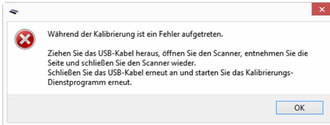
**Hinweis:** Wenn Sie versucht haben, den Scanner mit einer anderen Seite als der Kalibrierungsseite zu kalibrieren, die mit Ihrem Scanner geliefert wurde, wird die Kalibrierung fehlschlagen. Sie müssen den Scanner durch Ziehen und erneutes Verbinden des USB-Kabels aus- und wieder einschalten, und dann die Kalibrierung erneut starten.
