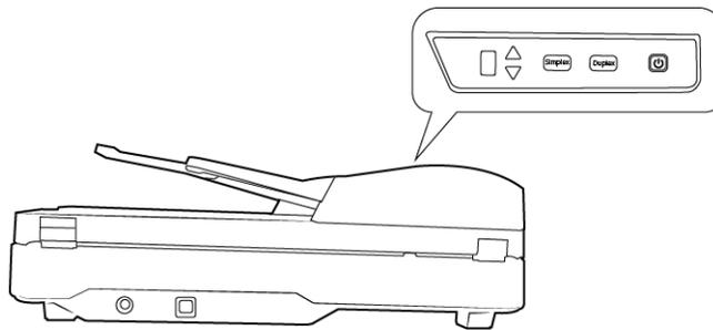
Die Statusleuchte blinkt. Damit wird angezeigt, dass der Scanner mit Strom versorgt wird.
