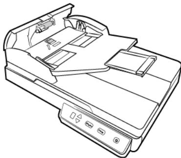
4. Schließen Sie den Deckel des automatischen Vorlageneinzugs. Drücken Sie den Deckel des automatischen Vorlageneinzugs vorsichtig nach unten, bis er mit einem Klick einrastet.
