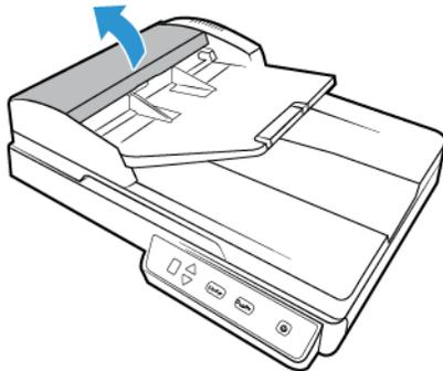
3. Wischen Sie die Einzugwalze nach einer Seite ab. Drehen Sie die Walze, um die gesamte Oberfläche zu reinigen. Die Einzugwalze befindet sich an der Unterseite der Klappe des automatischen Vorlageneinzugs.
