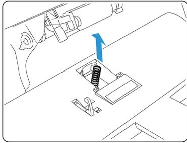
6. Platzieren Sie die neue Spannungsfeder im Scanner.
