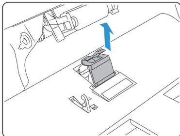
5. Entfernen Sie die Spannungsfeder, die sich unter dem ADF-Pad befindet.
