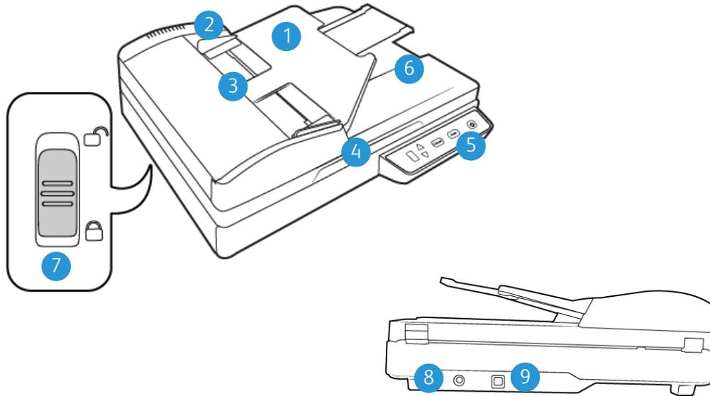
1. **Vorlagenfach:** Hält die Vorlagen in der korrekten Position im Scanner. Kann ausgeklappt werden, um Vorlagen verschiedener Längen zu halten.
