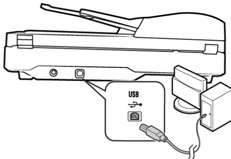
Wenn der Stecker nicht ohne Widerstand eingesteckt werden kann, vergewissern Sie sich, dass Sie ihn korrekt und in den richtigen Anschluss stecken. Drücken Sie den Stecker nicht gewaltsam in den Anschluss.
