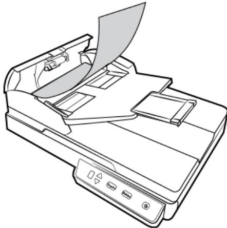
3. Schließen Sie den Deckel des automatischen Vorlageneinzugs. Drücken Sie den Deckel des automatischen Vorlageneinzugs vorsichtig nach unten, bis er mit einem Klick einrastet.
