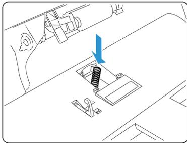
7. Platzieren Sie das neue ADF-Pad in den Scanner und drehen Sie es in die korrekte Position.
