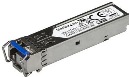
Le SFPGE10KT3R4 est un module de transceiver SFP fibre optique compatible Juniper SFP-GE10KT13R14 qui a été conçu, programmé et testé pour fonctionner avec des commutateurs et des routeurs de marque Juniper®. Il vous assure une connectivité de 1 GbE par câble en fibre optique, sur les réseaux compatibles 1000Base-BX10-U et sur une distance maximale de 10 km.
