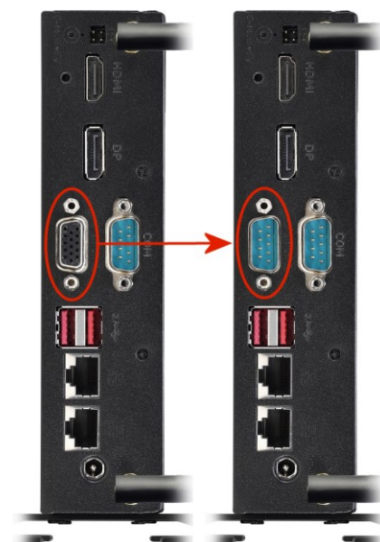
Shuttle XPC slim DS10U vor und nach dem Einbau von einem PCP11-Adapter
