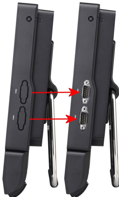
Shuttle XPC all-in-one P20U vor und nach dem Einbau von zwei PCP11-Adaptoren
