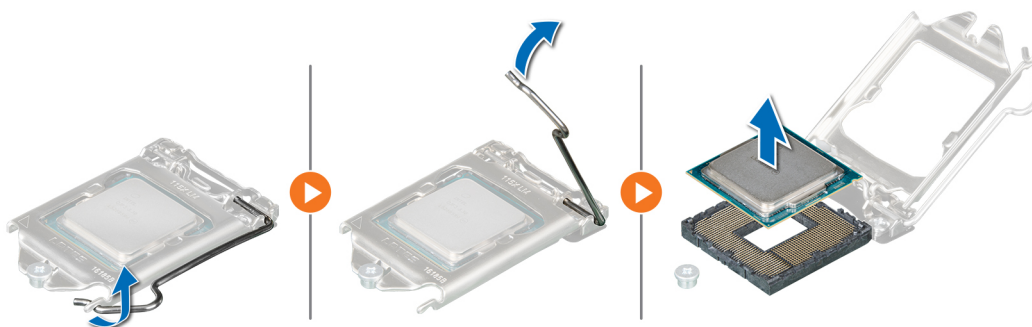
Figure 44. Retrait du processeur
