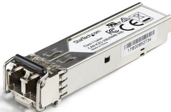
Le CTPSFP1GELXS est un module de transceiver SFP fibre optique compatible Juniper CTP-SFP-1GE-LX qui a été conçu, programmé et testé pour fonctionner avec des commutateurs et des routeurs de marque Juniper®. Il vous assure une connectivité de 1 GbE par câble en fibre optique, sur les réseaux compatibles 1000Base-LX et sur une distance maximale de 10 km.
