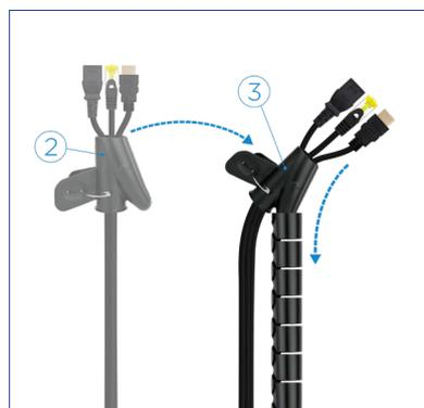
**Se introduce el adaptador** con los cables por un extremo del organizador.
