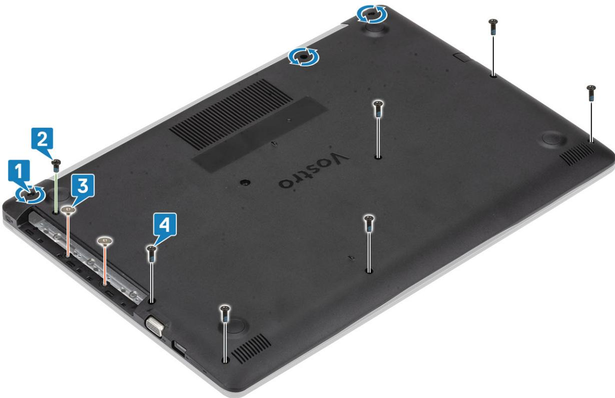
3. Haga palanca en la cubierta de la base desde la esquina superior derecha [1] y continúe haciendo palanca para abrir el lateral derecho de la cubierta de la base [2].
