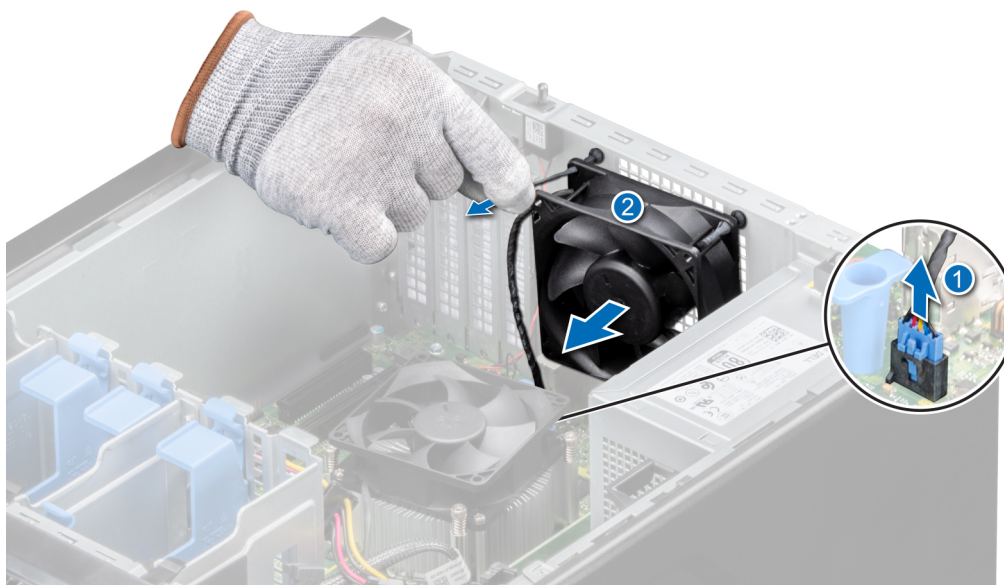
Figure 26. Retrait du ventilateur de refroidissement
