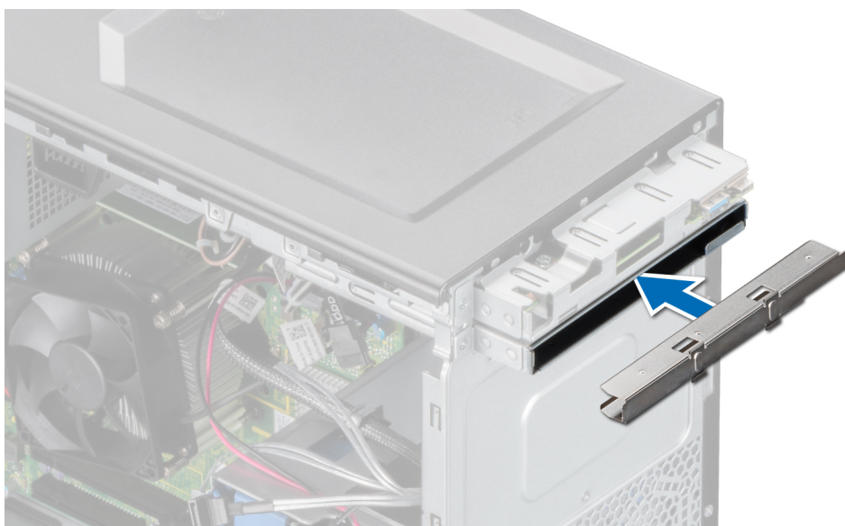
Figure 20. Installation du cache du lecteur optique dans le bâti du lecteur optique
