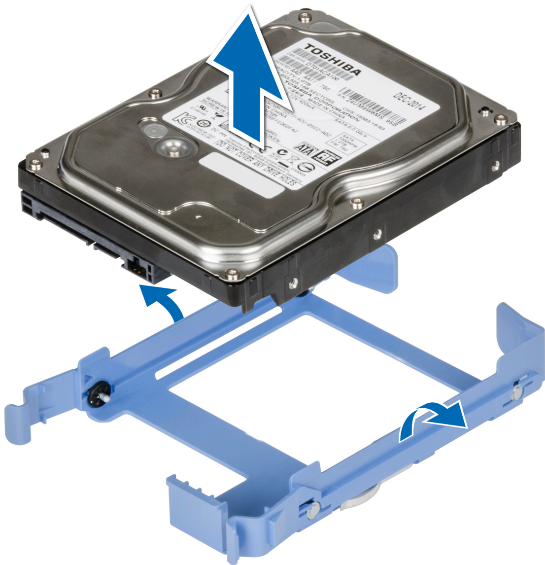
Figure 15. Retrait d'un disque dur installé dans un support
