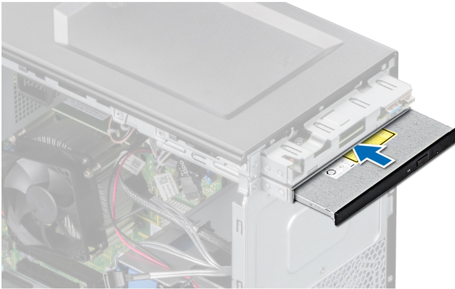
Figure 22. Installation du lecteur optique
