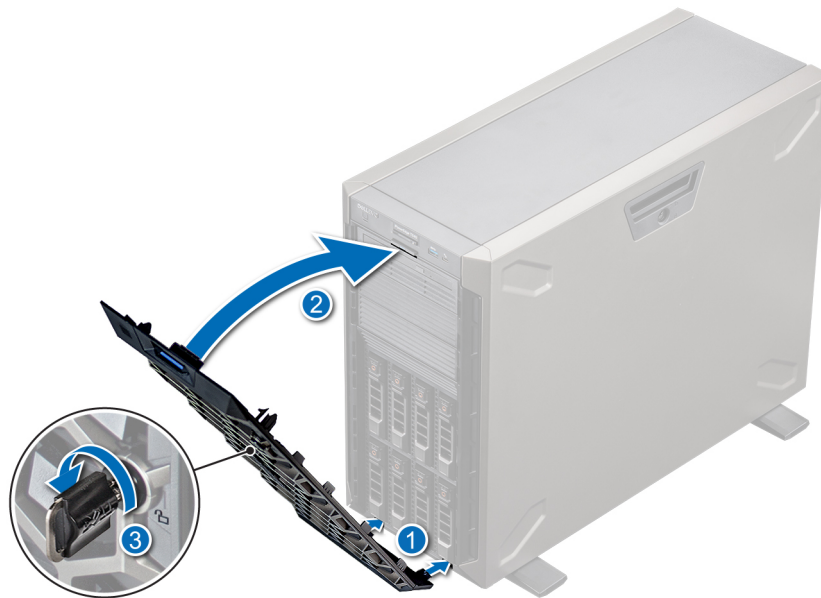
Figure 18. Installation du cadre avant
