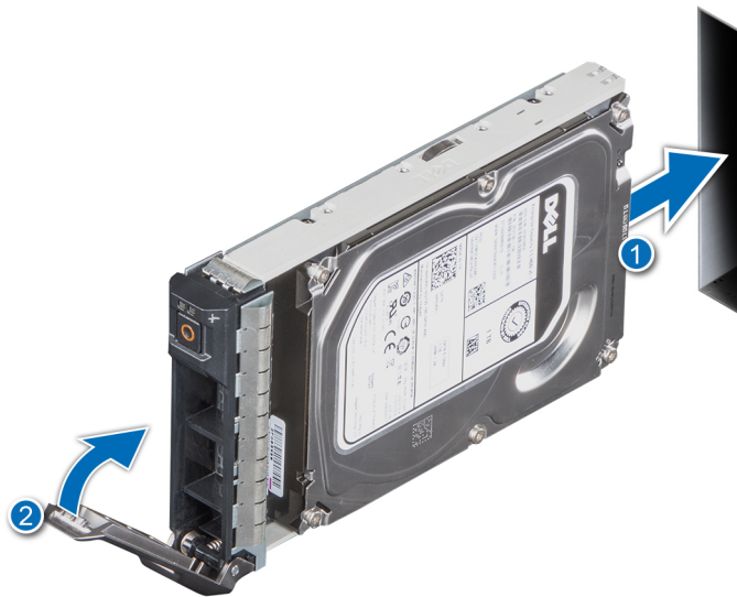
Figure 31. Installation d'un support de lecteur
