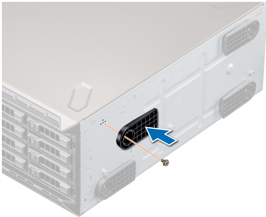
Figure 20. Installation des pieds du système
