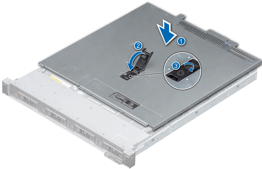
Figure 16. Installation du capot du système
