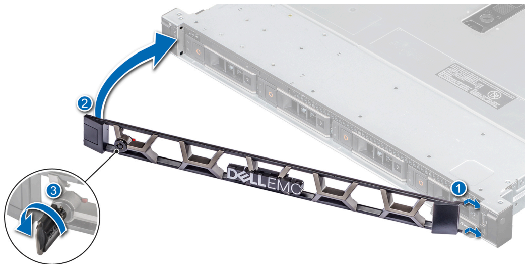
Figure 14. Installation du cadre avant optionnel
