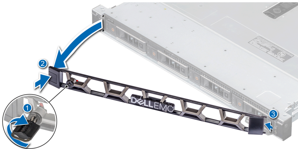
Figure 13. Retrait du cadre avant en option.
