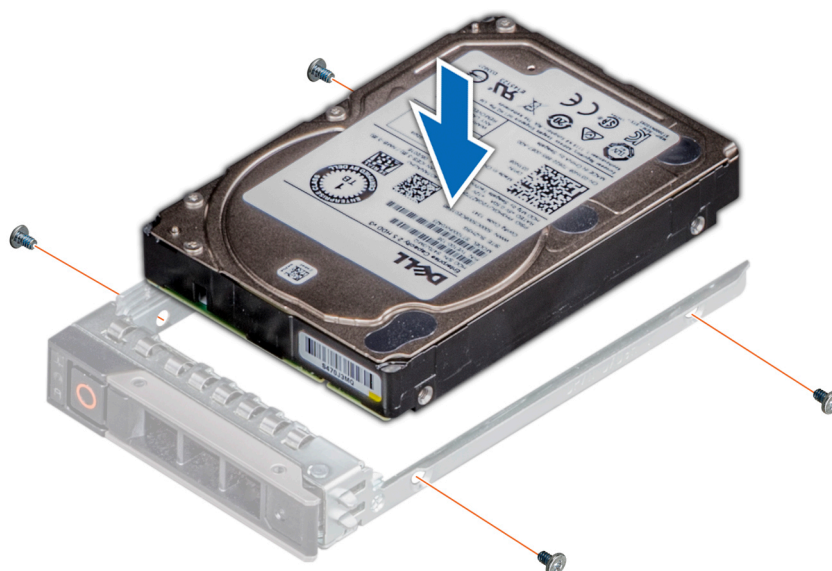
Figure 28. Installation d'un disque dans son support
