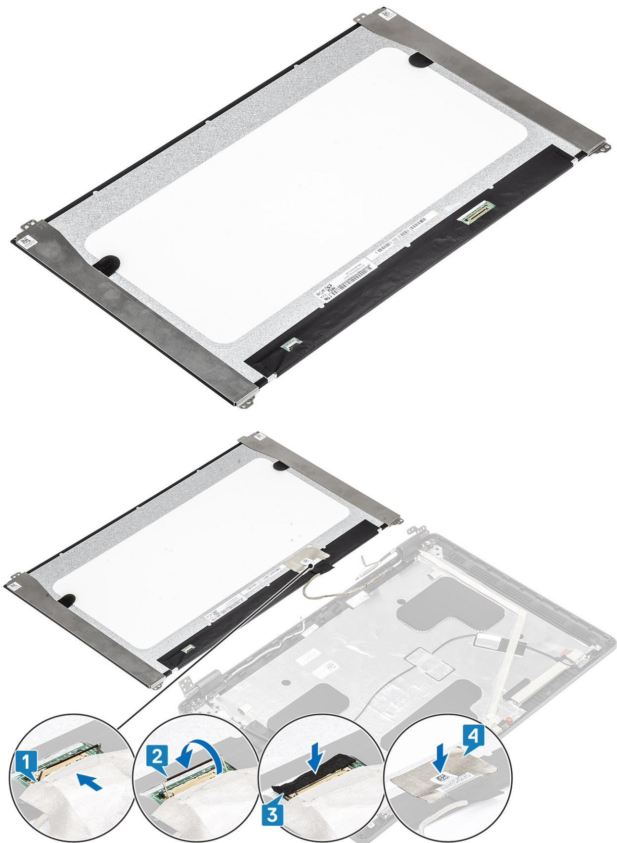
4. Remettez en place les quatre vis (M2x2) qui fixent le panneau d'écran à l'assemblage de l'écran.
