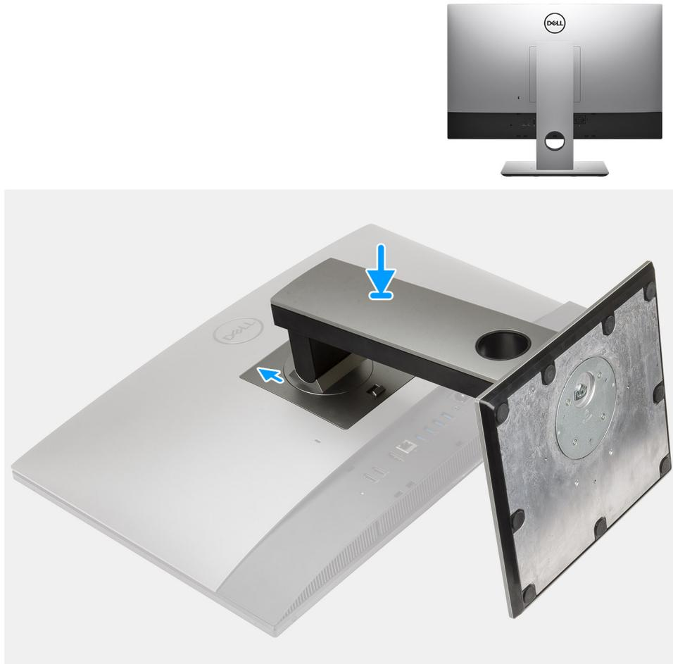
Figure 3. Socle réglable en hauteur
