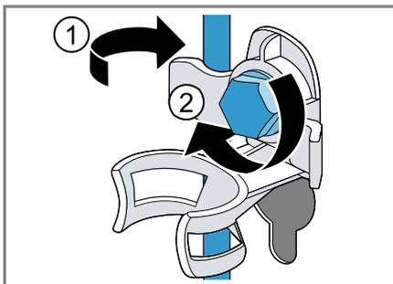
5. Inserire il tubo flessibile nell'alloggiamento.
