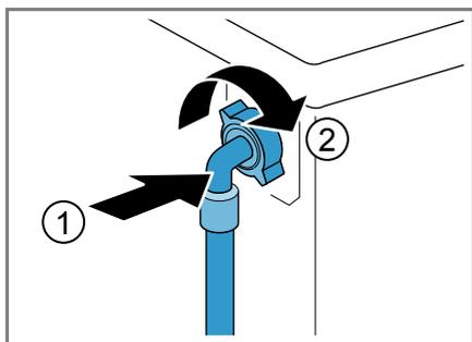
2. Collegare il tubo flessibile di carico dell'acqua al rubinetto (26,4 mm = 3/4").
