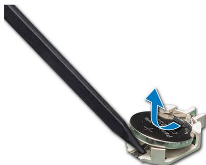
Figure 123. Retrait de la pile du système
