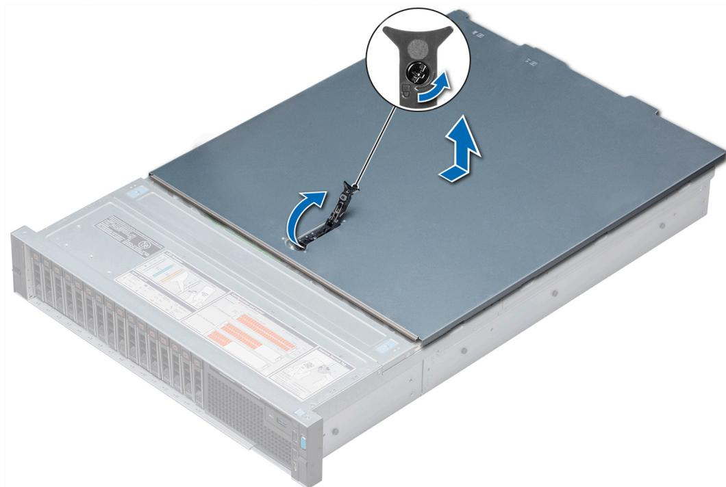
Figure 26. Retrait du capot du système
