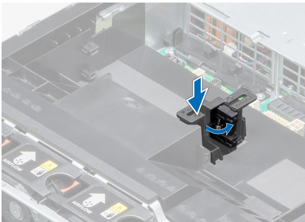
Figure 67. Ouverture du loquet du support de carte PCIe
