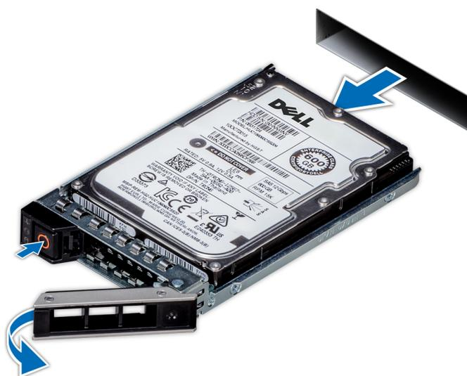
Figure 48. Retrait d'un support de disque
