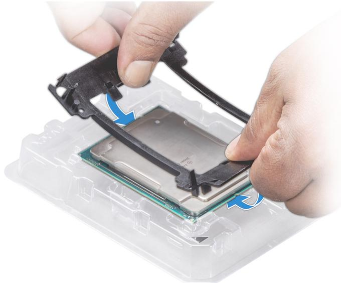
Figure 62. Installation du support de processeur
