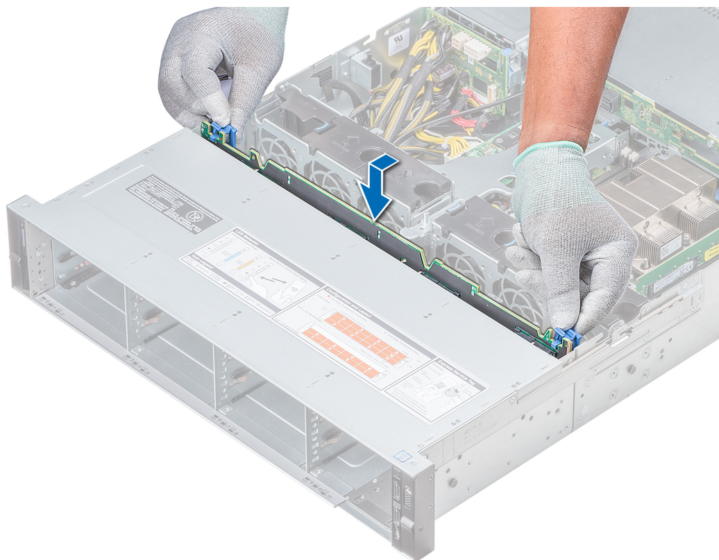
Figure 102. Installation du fond de panier
