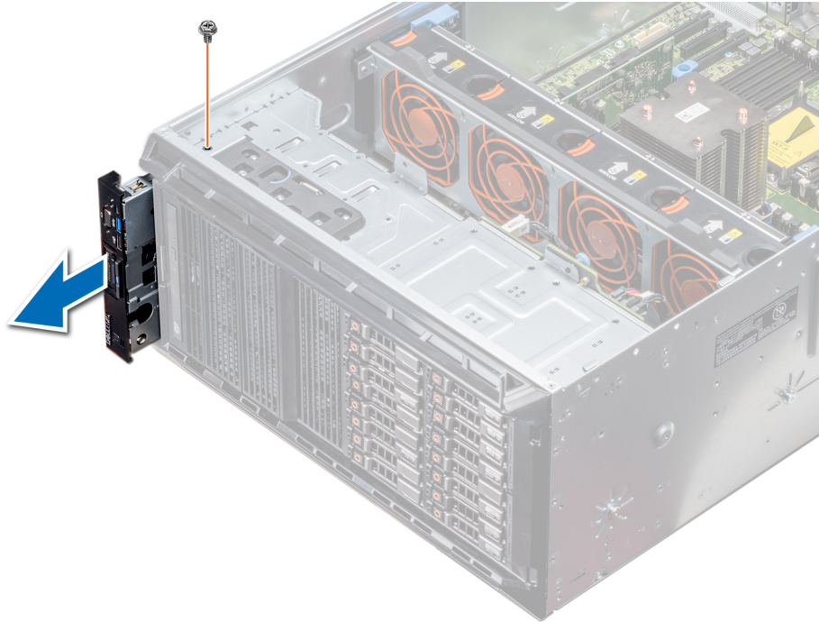
Figure 106. Retrait de l'assemblage du panneau de commande
