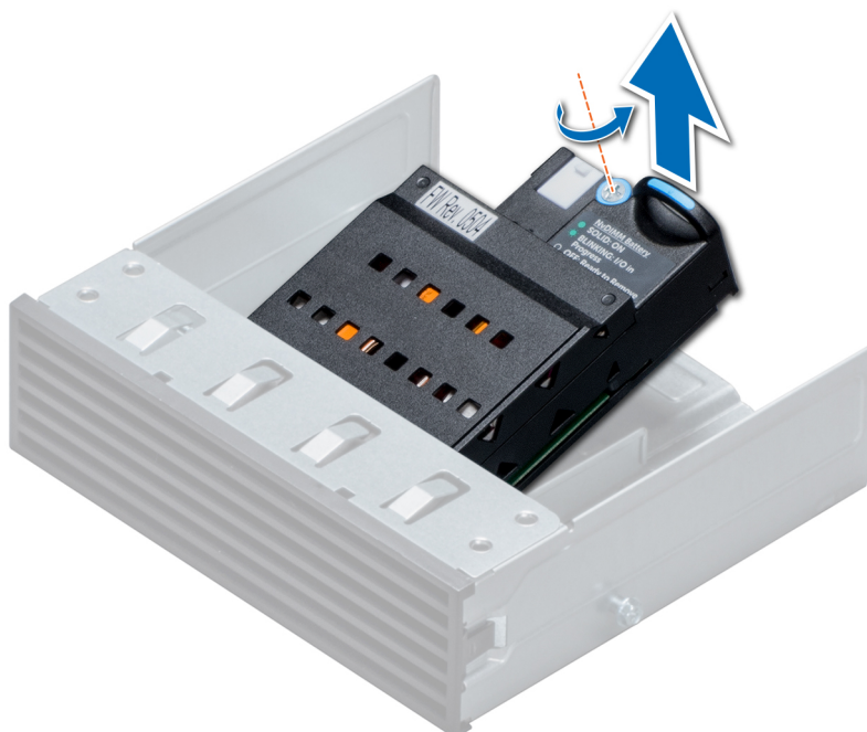
Figure 65. Retrait de la pile du module NVDIMM-N
