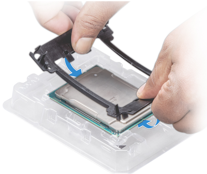
Figure 73. Installation du support de processeur
