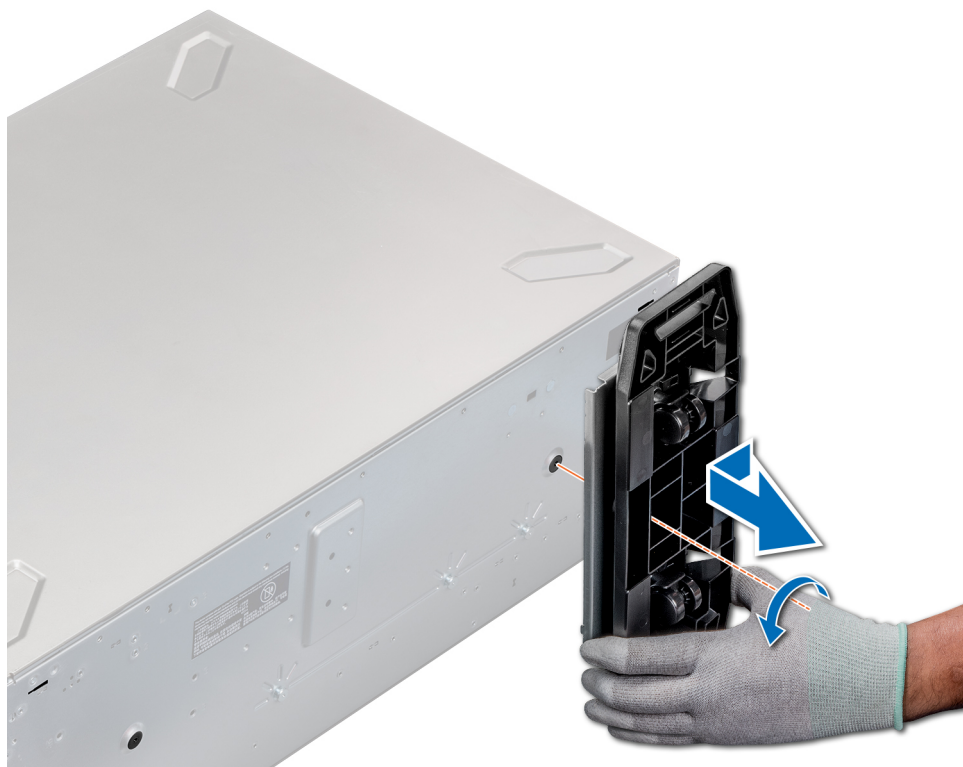
Figure 29. Retrait des roulettes
