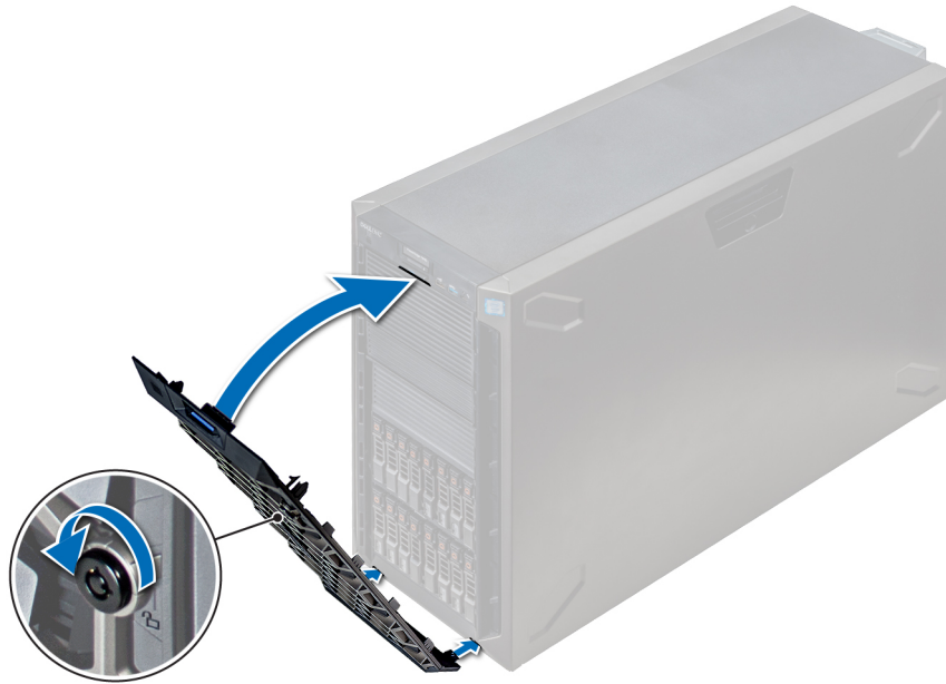
Figure 26. Installation du cadre avant
