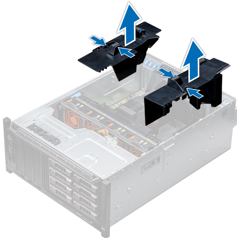
Figure 47. Retrait des carénages d'aération optionnels du GPU
