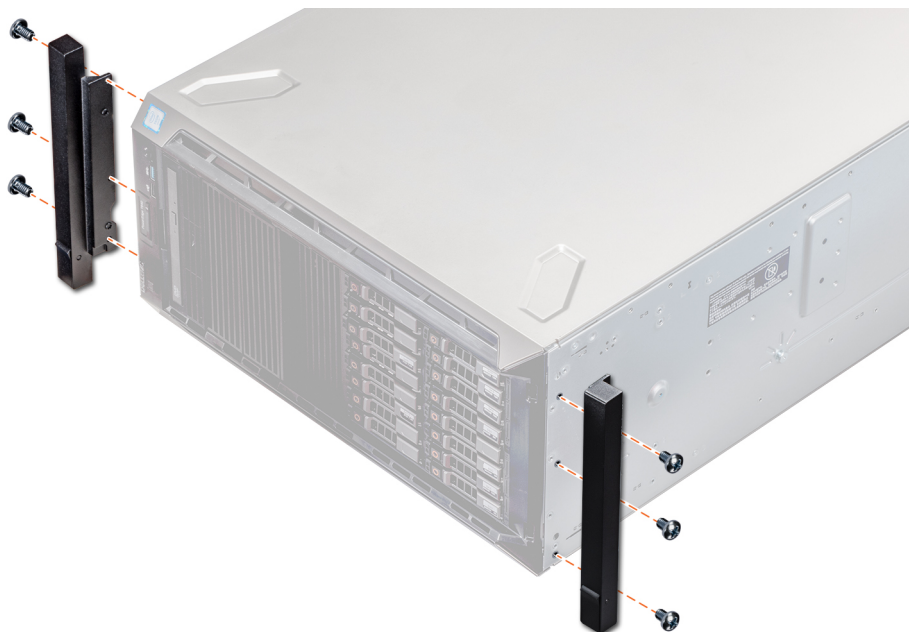
Figure 122. Installation des équerres du système
