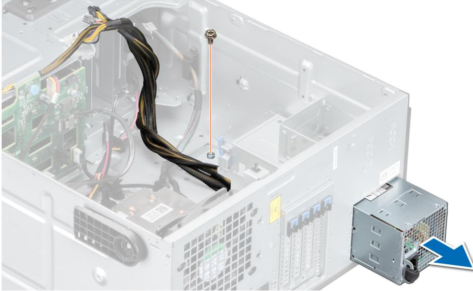
Figure 74. Retrait d'un bloc d'alimentation câblé
