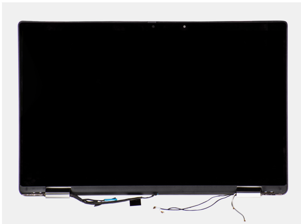
Figure 1. Assemblage d'écran avec câbles d'antenne
