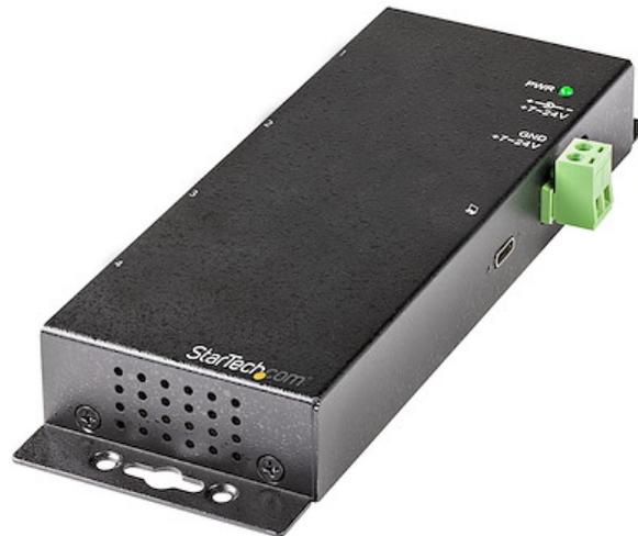
Grâce au hub USB industriel 4 ports permet de connecter 4 périphériques USB 3.2 Gen 2 (10 Gbps) à votre ordinateur USB-A or USB-C. Ce hub possède deux ports périphériques USB-A et USB-C avec un verrouillage vissable et un boîtier en métal industriel idéal dans des conditions industriel rudes.
