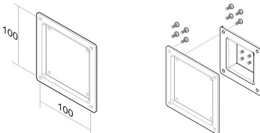
La piastra di adattamento NewStar, modello FPMA-VESA100 consente di convertire un modello di foro VESA 75x75 mm in 100x100 mm.
