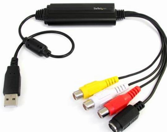
Il cavo di acquisizione per video compositi e S-Video USB 2.0 (SVID2USB23) è una soluzione analogica di facile utilizzo che consente di captare il segnale di una sorgente video composito e S-Video, insieme al relativo segnale audio RCA a due canali, e di trasmetterlo a un computer Mac® o Windows®.
