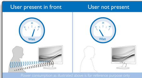
O PowerSensor é um "sensor de presença" integrado que transmite e recebe sinais infravermelhos inofensivos para reconhecer a presença do usuário. Esse recurso reduz automaticamente o brilho do monitor quando o usuário se afasta da mesa do computador, economizando energia em até 80% e prolongando a vida útil do monitor.
