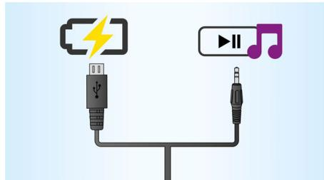
Este parlante Philips incluye un cable para cargar la batería y para reproducir música en modo entrada auxiliar. Esto elimina el enredo de cables y te permite disfrutar de una calidad de sonido sin interrupciones.
