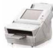
Escaneo de mezcla de documentos de diferentes tamaños, desde A8 hasta A4, mediante el ADF de 50 páginas. Tiene una velocidad de escaneo de 25 páginas por minuto en formato vertical A4 y a una resolución de 200 dpi en modo dúplex es posible el escaneo de 50 imágenes por minuto.
