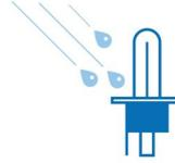
Solo una bombilla ardiendo fabricada con cristal de cuarzo (filamento a 2650 °C, cristal a 800 °C) puede soportar cambios bruscos de temperatura; por ejemplo, soporta sin explotar el goteo de agua fría sobre el cristal caliente de la bombilla, algo que puede suceder al conducir con un faro delantero roto y si hay agua en el entorno.
