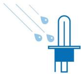
Только лампа из кварцевого стекла (нить накаливания 2650 °C, стекло 800 °C) может во включенном состоянии противостоять резким перепадам температуры: например, при попадании капли холодной воды
