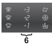
Die Anzeige zeigt die Anzahl der ausgewählten Zusatzspülgänge an. Diese können je nach Programm über die entsprechende Taste angepasst werden.
