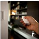
Der Schalter ist magnetisch und kann von der Rückplatte abgenommen werden. So können Sie den Philips hue-Dimmerschalter auch als Fernbedienung für Ihr Licht mit einer Reichweite in Innenräumen von bis zu 12 Meter verwenden.
