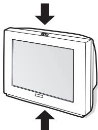
Los botones VOLUME - + (- +) permiten ajustar el sonido. Los botones PROGRAM - + (- P +) permiten seleccionar los programas deseados. Para acceder a los menús, mantenga pulsados los 2 botones - y + (o el botón MENU). Los botones PROGRAM - + pueden entonces ser utilizados para seleccionar un ajuste y los botones - + para efectuarlo. Para salir de los menús, mantenga pulsados los 2 botones - y + (o el botón MENU).
