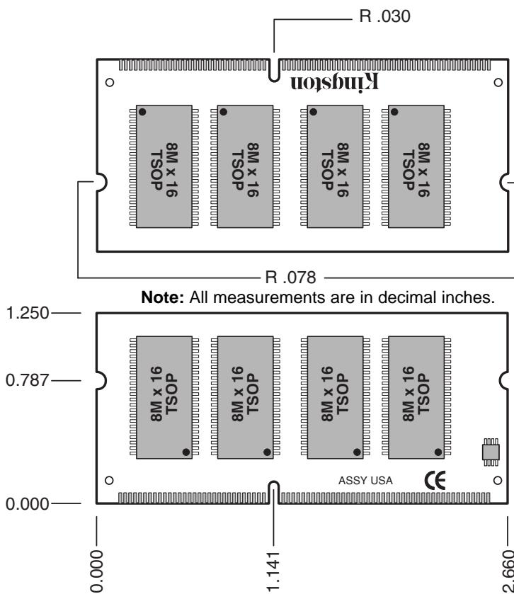
Figure 1: KVR133X64SC3/128 144-Pin SDRAM Module
