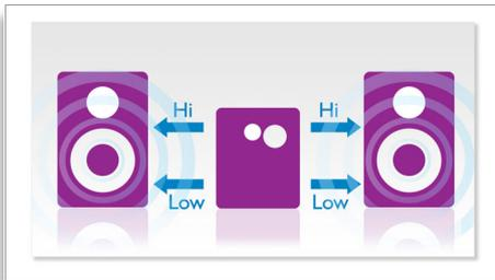
El amplificador doble optimiza el rendimiento del sonido: reduce la intermodulación entre el woofer y el tweeter porque cada transductor está controlado por su propio amplificador. Como resultado, los sonidos graves son más profundos y potentes. Además, generan interferencias mínimas con las frecuencias más altas para ofrecerte un audio puro y detallado. A esto se le suma el diseño de filtro de cruce activo que logra un mejor control en la fase y la frecuencia de respuesta de cada transductor
