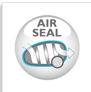
Cet aspirateur Philips a été conçu de telle sorte que tout l'air aspiré passe à travers le filtre lavable HEPA 13 (filtration à 99,95 %) avant d'être évacué. Aucune fuite possible !
