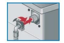
1. Según modelo: Conectar la manguera de entrada de agua (mangueras) al grifo (grifos) 3/4" = 26,4 mm y a las electroválvulas. **Advertencia:** apretar las conexiones únicamente a mano.
