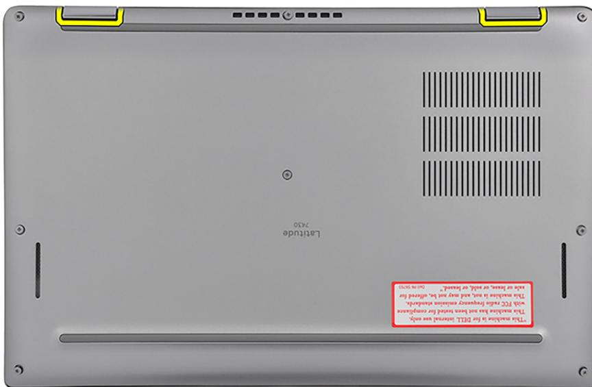
**PRÉCAUTION :** Ne glissez pas la pointe sous le bord du côté supérieur du cache de fond, car cela risque d'endommager les loquets du cache.
