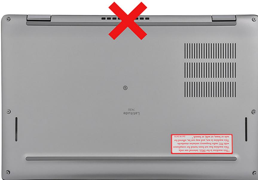
3. Faites levier pour ouvrir le côté supérieur du cache de fond, puis sur les côtés inférieur, gauche et droit pour ouvrir le cache de fond.
