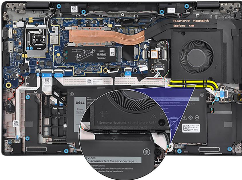
4. Retirez les deux vis (M2x2,5) qui fixent le ventilateur thermique et les quatre vis (M2x2,5) qui fixent le dissipateur thermique à la carte système.
