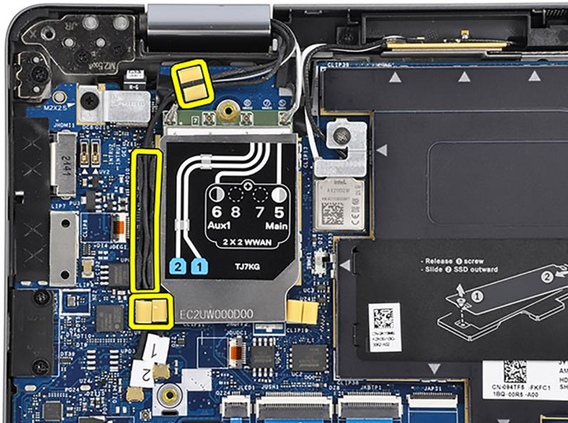
13. Branchez le câble d'antenne Darwin n° 1 et le câble d'antenne Darwin n° 2 sur leurs connecteurs respectifs sur la carte système.
