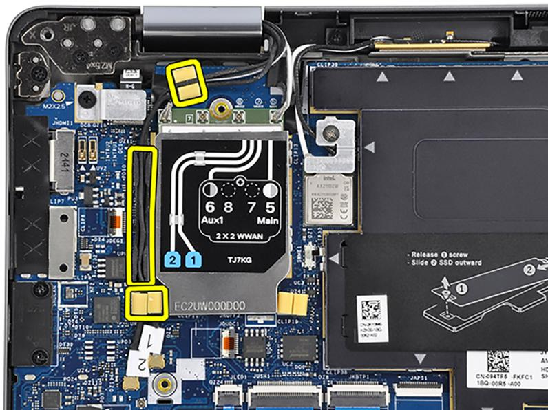
10. Branchez le câble d'antenne Darwin n° 1 et le câble d'antenne Darwin n° 2 sur leurs connecteurs respectifs sur la carte système.
