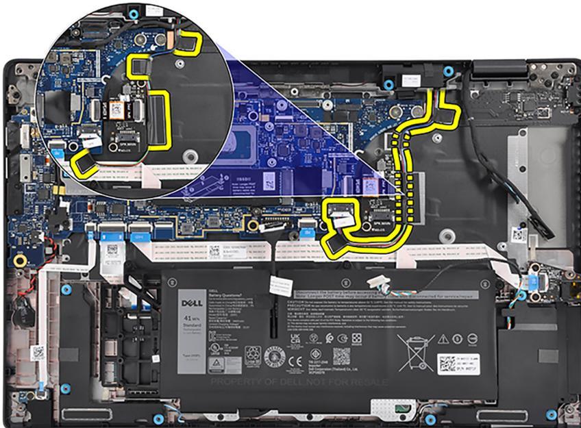
3. Collez le ruban adhésif pour fixer le câble du haut-parleur d'aigus sur la partie supérieure du châssis inférieur.
