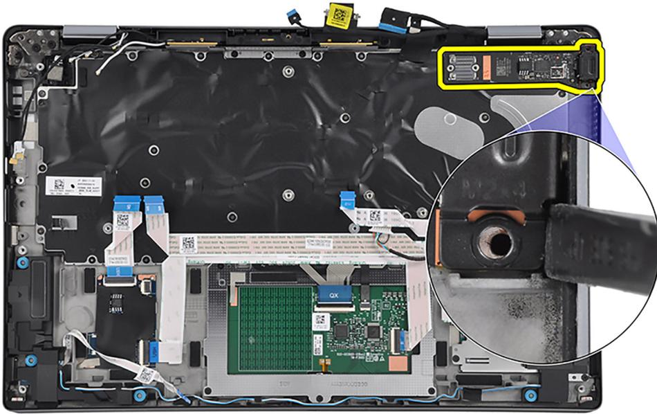
5. Soulevez la carte fille d'E/S pour la retirer de l'assemblage du repose-poignets et du clavier.
