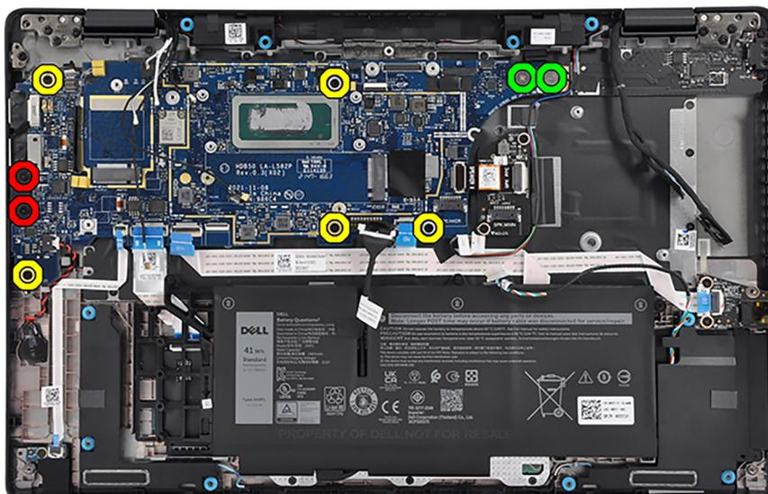
4. Remettez en place les quatre vis (M2x2,5), les deux vis (M2x4) et les deux vis (M2x3) pour fixer la carte système à l'assemblage du repose-poignets et du clavier.
