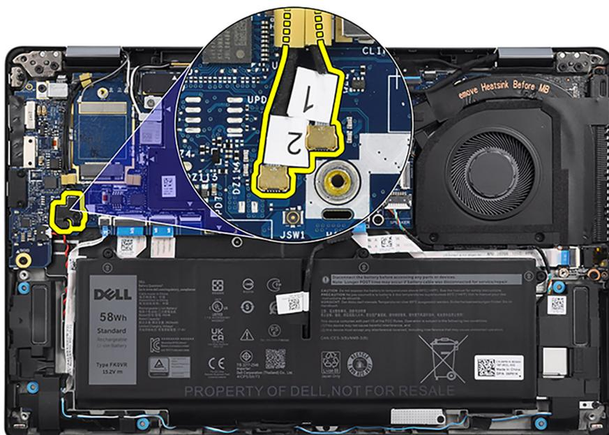
8. retirez le câble d'antenne Darwin n° 1, le câble d'antenne Darwin n° 2, le câble d'antenne Aux1 WWAN noir/gris n° 6 et le câble d'antenne principal WWAN n° 5 blanc/gris des guides d'acheminement respectifs sur l'assemblage du repose-poignets et du clavier.
