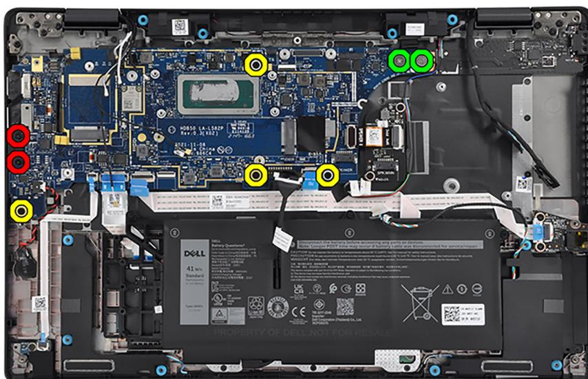
16. Retirez les cinq vis (M2x2,5), les deux vis (M2x4) et les deux vis (M2x3) qui fixent la carte système à l'assemblage du repose-poignets et du clavier.
