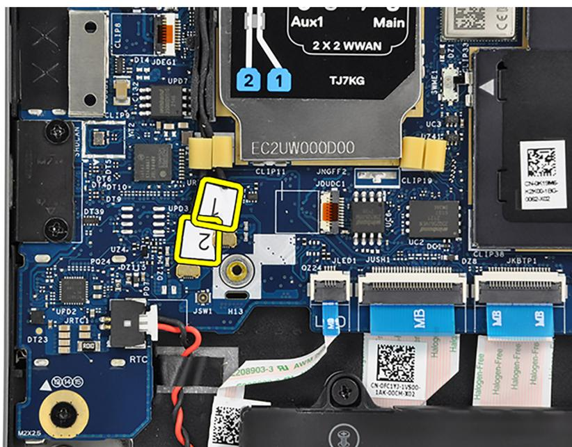
7. retirez le câble d'antenne Darwin n° 1, le câble d'antenne Darwin n° 2, le câble d'antenne Aux1 WWAN noir/gris n° 6 et le câble d'antenne principal WWAN n° 5 blanc/gris des guides d'acheminement respectifs sur l'assemblage du repose-poignets et du clavier.
