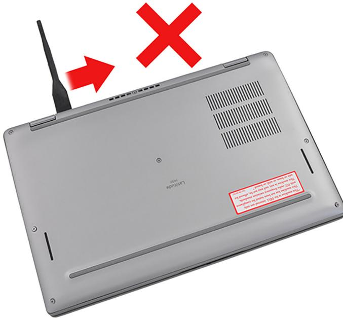
**PRÉCAUTION :** Ne faites pas levier sur le bord supérieur à proximité de l'aération située sur la partie supérieure du cache de fond. Cela peut endommager le cache de fond.
