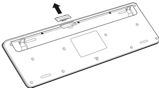
2. Inserire le batterie AAA nel vano batterie. Quindi, chiudere il coperchio della batteria.
