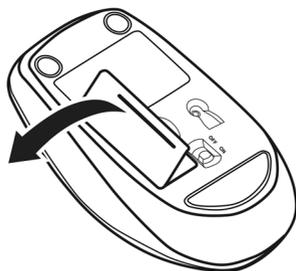
2. Inserire la batteria AA nel vano batterie.
