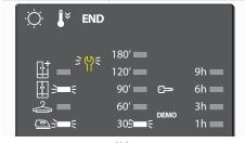
La présence du symbole de la clé anglaise indique une anomalie. Effectuer les opérations décrites. Éteindre le sèche-linge et le débrancher du réseau électrique. Ouvrir immédiatement la porte et extraire le linge, de façon à ce que la chaleur puisse se dissipée. Attendre une heure environ. Rebrancher le sèche-linge au réseau électrique, charger le linge dans le panier et lancer le cycle de séchage.
