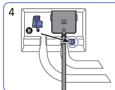
4 Inserire il fermacavi nel foro per fissare i cavi.
