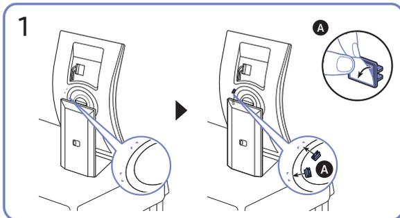
1 Fissare i passacavi alla scanalatura sul retro del monitor.
