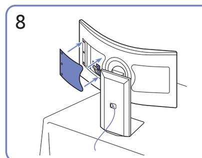
8 Chiudere il coperchio posteriore per completare il processo.
