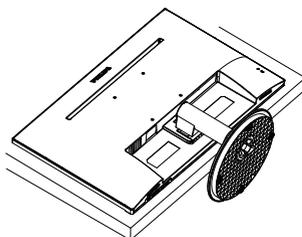
2. Drücken Sie zum Entfernen der Basis von der Basissäule die Freigabeclips zusammen.
