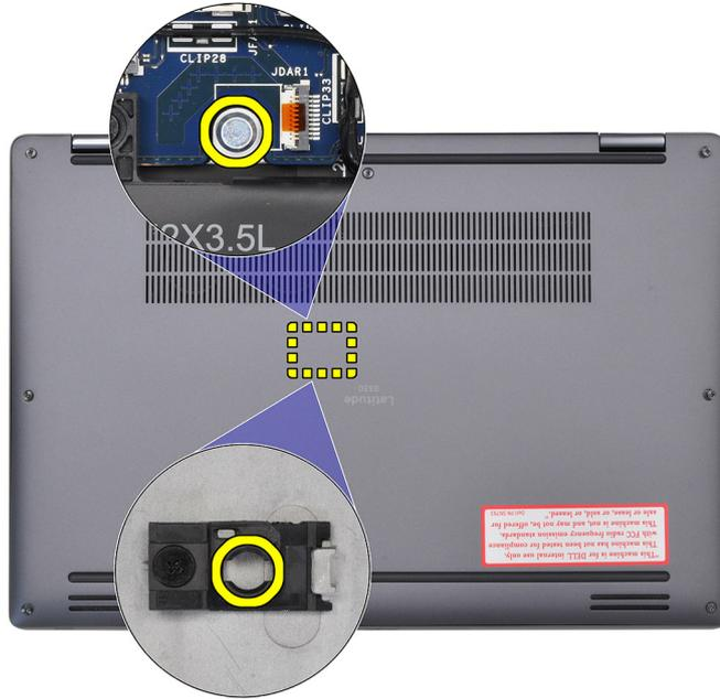
3. Serrez les huit vis imperdables pour fixer le cache de fond à l'assemblage du repose-poignets et du clavier.
