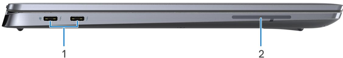
1. Thunderbolt 4-Anschlüsse (USB Typ-C) mit DisplayPort Alternate-Modus / USB4 / Power Delivery
