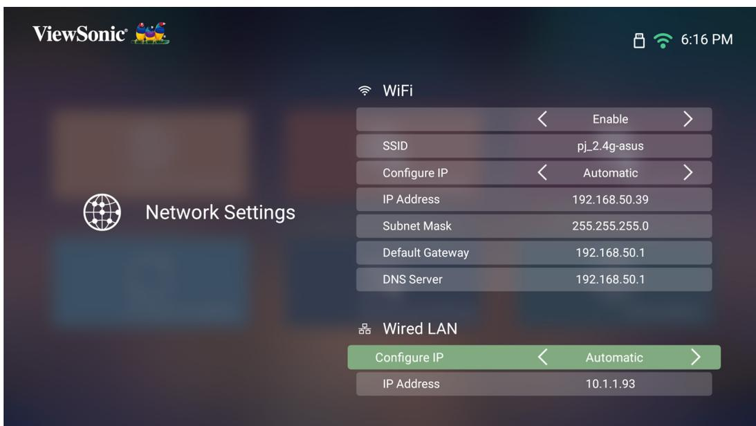
3. È possibile configurare l'IP in automatico o manualmente. Scegliendo **Manual (Manuale)** sarà possibile inserire **IP Address (Indirizzo IP)**, **Subnet Mask (Maschera di sottorete)**, **Default Gateway (Gateway predefinito)** e **DNS Server (Server DNS)**.
