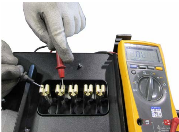
Figura 5: Prueba de aislamiento de la unidad enchufable antes de la instalación
