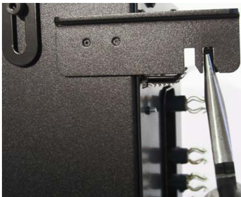
Figura 10: Extracción del recorte premarcado (225 A)
