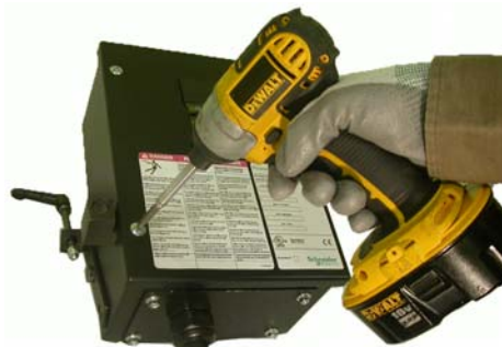
Figure 16 : Retrait des vis du couvercle pour ouvrir le coffret (PBPQOD, PBPQHD)
