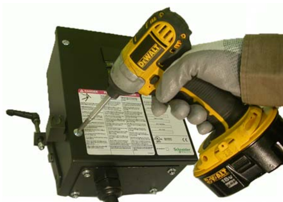
Figure 4 : Fixation du couvercle de l'unité enfichable, arrière et bas (PBPQOD, PBPQHD)
